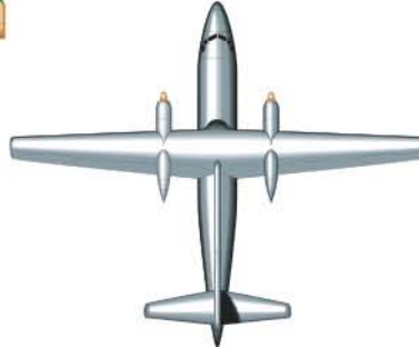
voilure F trapézoïdale tapered wing ala F trapezoidal Trapezflügel M ala F trapezia
